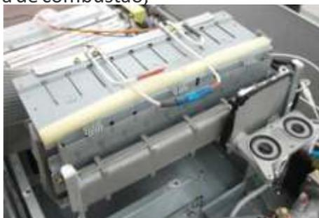
10-Retirar os 2 para parafusos que fixam o distribuidor de gás ao conjunto queimador;
